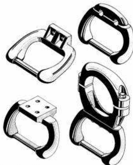
Obr. 8: pevné kontakty na živých částech - hrazdičky
